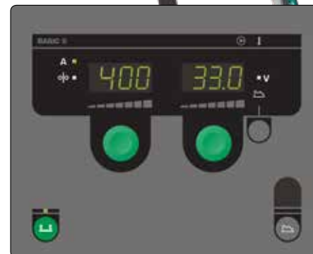
Panel sterowania Basic do ręcznego ustawiania parametrów spawania.
